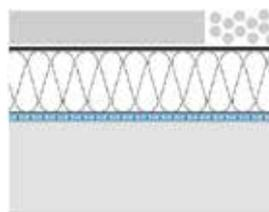
A membrana MMA é usada para impermeabilizar o substrato e é recoberta com isolamento, cascalho, areia ou pavimentação.
