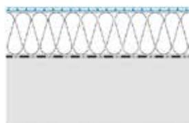
Com isolamento no substrato, o revestimento MMA é a última camada.
