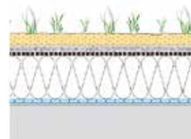
A membrana MMA é usada para impermeabilizar "telhados verdes" com vegetação leve irrigada.
