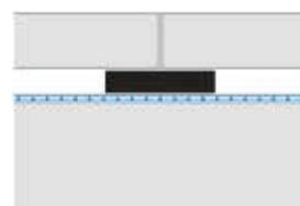
A membrana MMA é usada para impermeabilizar o substrato e é recoberta com pavimentação com uma base de argamassa ou sobre suportes.
